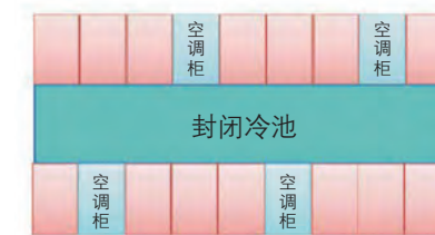
双排封闭冷通道安装示意
