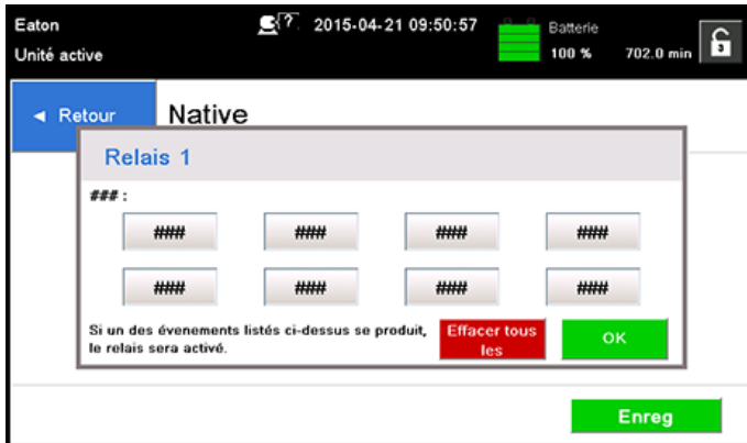
Figure 42. Saisie des codes des fonctions déclenchant le relais
