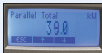
Afficher la sortie système complète de n'importe quelle ASC
