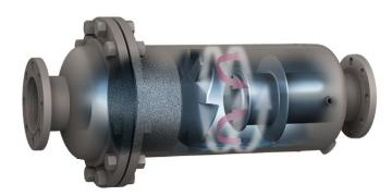
Der Typ CLC-Zentrifugal-Inline-Gas-/Flüssigkeitsabscheider von Eaton setzt auf eine bewährte Abscheidertechnologie, um 99 Prozent aller Feststoff- und Flüssigkeitspartikel größer als 4 Mikrometer zu entfernen. Ein chinesisches Stahlwerk hat die Luftverschmutzung praktisch vollständig beseitigt, kostspielige Schmierstoffe zurückgewonnen und die Betriebskosten mit einem System auf Basis des Typs CLC-Koaleszenz-Abscheider gesenkt.
