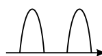
Les courants pulsés avec composants à courant continu peuvent être détectés par les DDR de type A et F.
