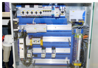
Die Steuerung wertet die Daten mehrerer Sensoren und Aktoren aus, zum Beispiel von Messlasern, Spiegel-Verstellantrieben, Teileerkennung, Vorschubpendel, Hobelwellenantrieben und -position, Sicherheitslaser usw.
