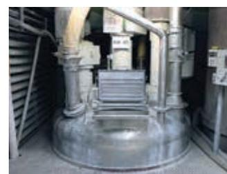
Eines der Dinova-Rührwerke, das mit Eaton-Technologie angetrieben wird, hat ein Fassungsvermögen von 10.000 l (Quelle: Dinova)
