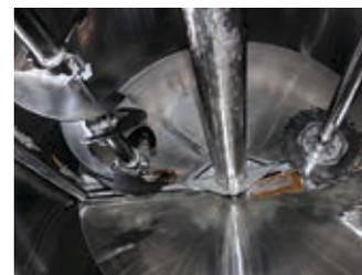
Im Rührkessel: Der Eaton-Frequenzumrichter steuert die Geschwindigkeit des Dissolvers (r.), der die Feststoffteilchen der Ausgangsprodukte zerkleinert. Mischer (l.) und Abstreifer (m.) laufen langsam mit (Quelle: Dinova)
