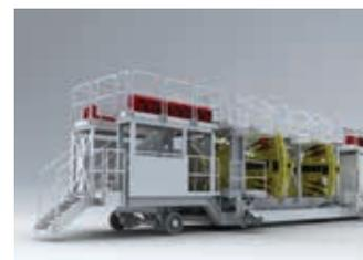
Eine bemerkenswerte Leistung der Technik - der Crossrail-Bohrautomat, bestehend aus zwei Maschinenteilen, bewegt sich durch die Tunnel und bohrt mehr als 250.000 Löcher ins Tunnelfutter.
