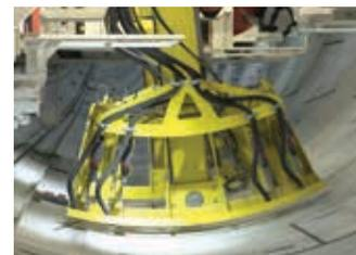
Der Crossrail Bohrautomat im Themse Tunnel, der sich fast zwei Meilen unter der Stadt London erstreckt. Eatons Heavy Duty Serie von Axialkolbenpumpen versorgt die Hydrauliksysteme mit Hydrauliköl, die sowohl die Arme bedienen, als auch die 36 Bohrer steuern.
