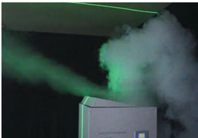
Modo de acción de la campana extractora durante la prueba de funcionamiento ILK Dresden.
