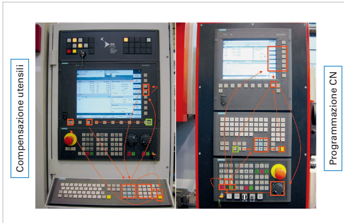
Figura 1.2 – Sequenza di input su un sistema di controllo tradizionale basato su funzioni
