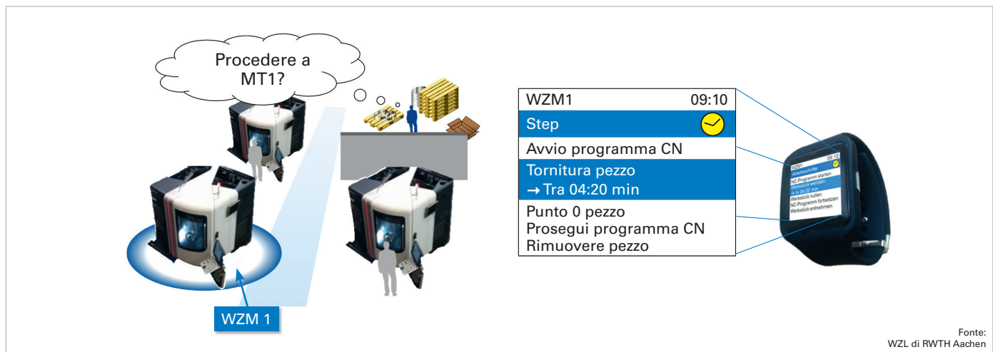
Figura 3.7 – Monitoraggio remoto delle macchine utensili attraverso dispositivi smart [MaxiMMI]
