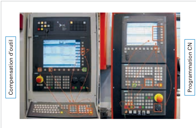
Illustration 1.2 : Etapes de travail d'un système de commande standard fonctionnel [KOLS14]
