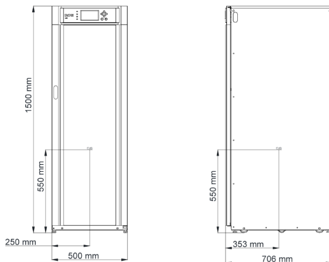
Figura 12. Baricentro dell'armadio dell'UPS (Eaton 93E 40 kVA) con le batterie
