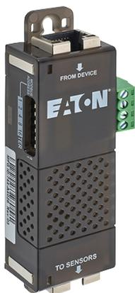
Il nuovo EMP conserva tutte le funzionalità della precedente generazione di sensori (monitoraggio di temperatura, umidità e contatto pulito) aggiungendo la possibilità di collegamento in serie (fino a 3 per host), rendendo possibile la connessione di più sensori ad un singolo host.
