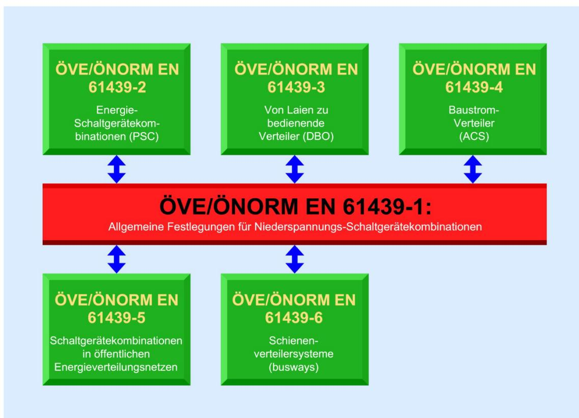
Bild 1-1 Überblick über die anerkannten Regeln der Technik ÖVE/ÖNORM EN 61439; Stand 1/2014
