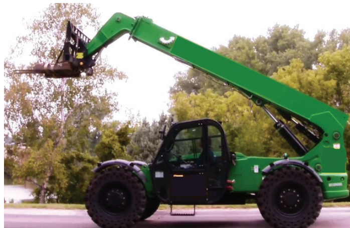
Abbildung 3: Ein Teleskoplader wurde eingesetzt, um Ventile unter typischen Betriebsbedingungen zu testen.
